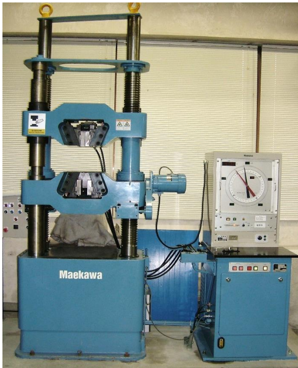
■ 油圧式万能試験機 (1000kN)
